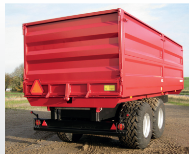
Hydraulisk bagsmæk med dobbelt virkende cylinder.
