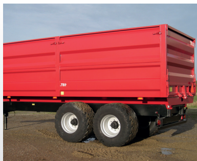
Langsgående sider er delt med 2 stk. kraftige profilstolper.
