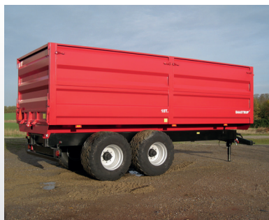
Aftagelige kornsider. Nederste del af kassen er 80 cm høj, kornsiderne er 90 cm høje.
