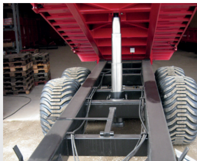
Cylinder med 6 led. Kraftig undervogn.
