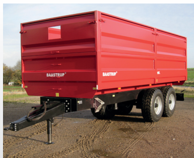
Kassen er opbygget kasse med fuldsvejse-ladsider, profileret 45 graders overgang fra bund til sider.
