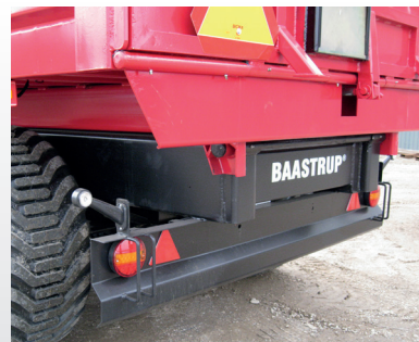
Lovpligtigt led lysanlæg er monteret. Tud i bagsmæk (ekstra udstyr).
