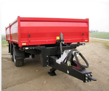
Hydraulisk støttefod (standard). Affjedret træk som ekstra udstyr.
