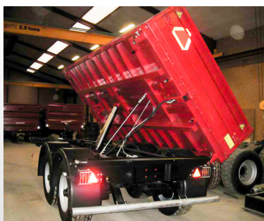
Kardanophængt cylinder, med 6 led. 3-vejestip beslagene er med lastbildele.
