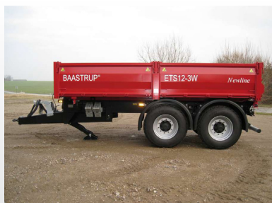
5 mm pladebund med faste hjørne- stolper. Siderne er delte på midten og er udført som profalbukkede 4 mm plade.
