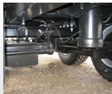
Vognen er monteret med bogie og bremses på begge aksler.
